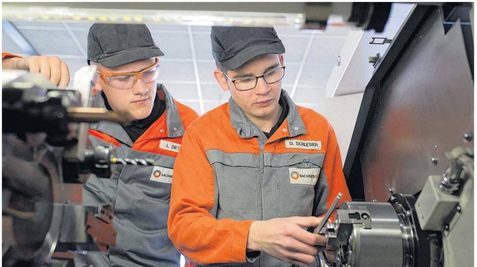
Leon Dietze (links) wird bei Sachsen Guss zum Gießereimechaniker ausgebildet, Daniel Schlesier zum Industriemechaniker. Hier sind sie mit dem Einstellen eines Hydraulikfutters einer CNC-Drehmaschine beschäftigt. Sachsen Guss sucht bei der Messe am Wochenende neue Auszubildende. FOTO: MICHAEL BADER
